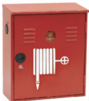
**Caratteristiche costruttive:** realizzata in lamiera zincata da 7/10 mm, verniciata a base di resina poliestere rossa RAL 3006 a norma ISO 9227 con elevata resistenza agli agenti atmosferici. La cassetta è dotata di pannello con apertura a 180° con simbolo adesivo di identificazione, istruzioni di installazione, d'uso e manutenzione.
