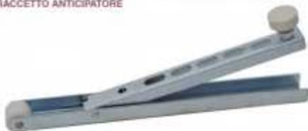
L'anticipatore di apertura applicato sull'anta secondaria, serve a compenare la forza di resistenza e la possibilità di blocco delle ante, spingendo su quella secondaria. L'anticipatore di apertura va controllato periodicamente per verificarne il corretto funzionamento effettuando le corrette ed opportune regolazioni necessarie.
