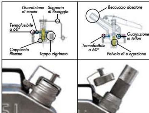
Bocchettone e beccuccio sono muniti di valvola termofusibile che interviene quando la temperatura supera i 60° C facendo fuoriuscire i gas sotto pressione che si sono formati all'interno del recipiente.
