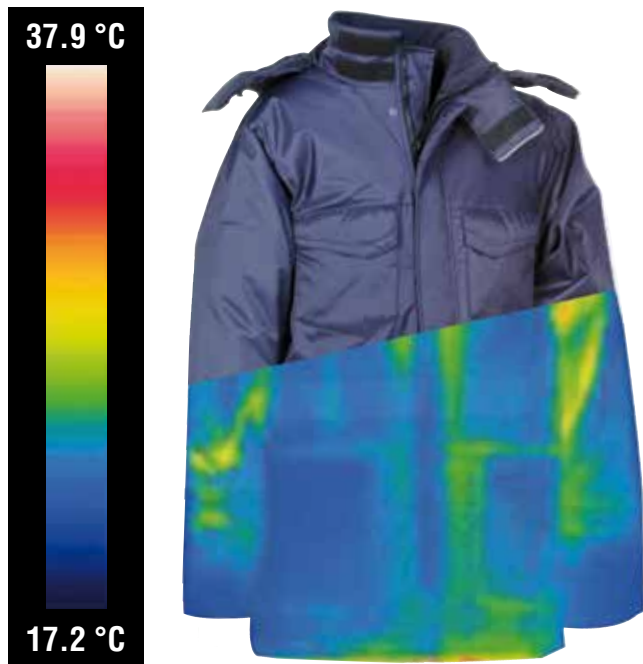
La colorazione tendente al blu dimostra la mancanza di vie di fuga di aria calda dal capo.
