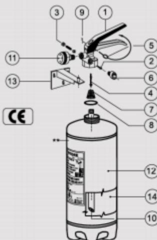
\*\* Marchiatura serbatoio (Ente di Sorveglianza) **CE 1370**, produttore serbatoio, decimale anno produzione, (Codice identificativo produttore) **0095**, n° matricola serbatoio, (Pressione di collaudi) PT xx Bar.
