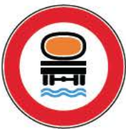
F.R 262 064 B transito vietato ai veicoli che trasportano prodotti suscettibili di contaminare l'acqua
