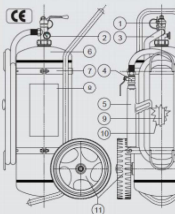
\*\* Marchiatura serbatoio: (Ente di Sorveglianza) CE 1370, produttore serbatoio, decimale anno produzione, (Codice identificativo produttore) 0095, n° matricola serbatoio, (Pressione di collaudi) PT xx Bar.
